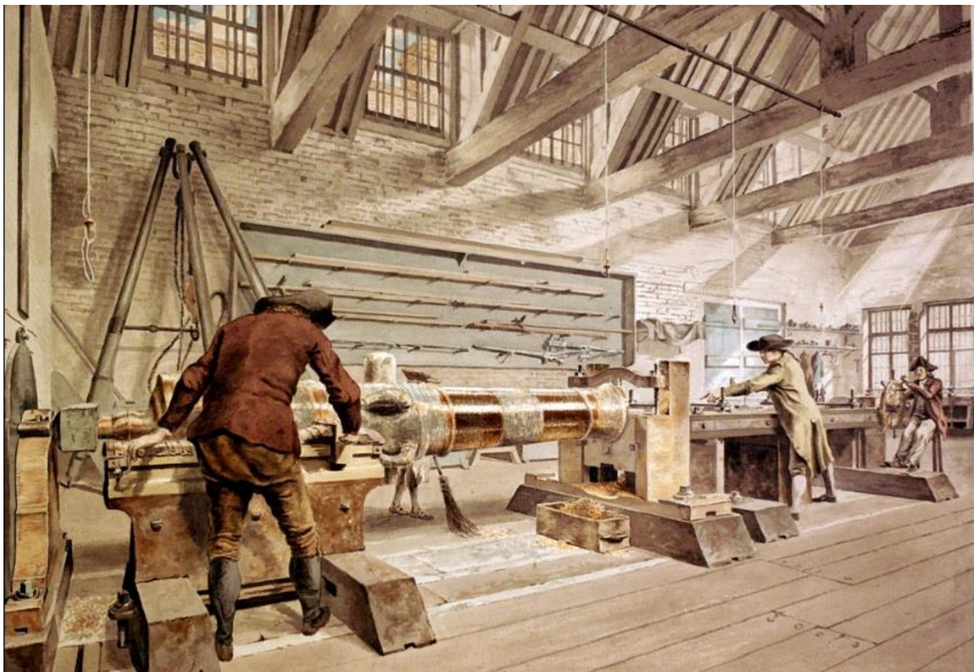
Pieter Verbruggen, 1 Royal Brass Foundry, 1778. Zijn vader staat hier achter zijn uitvinding om kanonnen met een draaibank uit te boren.
